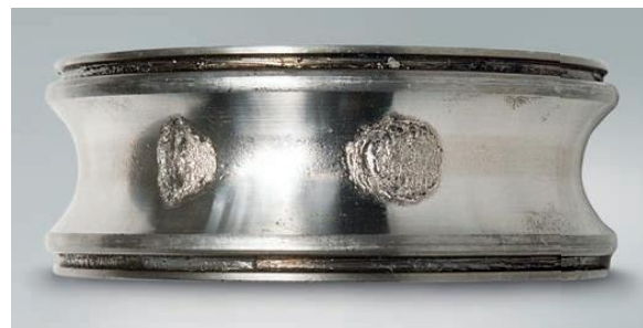
Figura 1 - Escamamento na pista no intervalo da esferas
